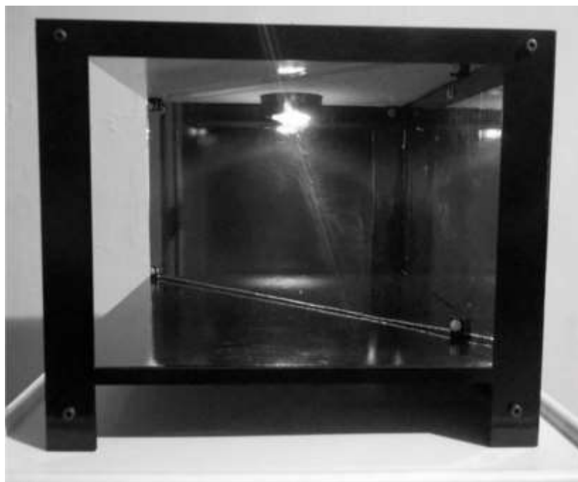
Рисунок 3.3. Вигляд спереду голографічної 3D вітрини «uScreener», без світловипромінювальної панелі, що відтворює зображення
