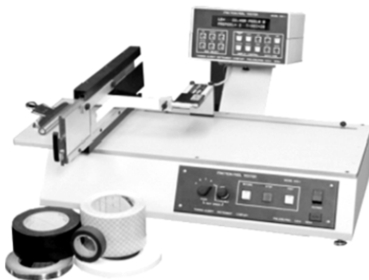
Рис. 1.1. Промисловий прилад для визначення коефіцієнта тертя Coesfeld Friction Tester
