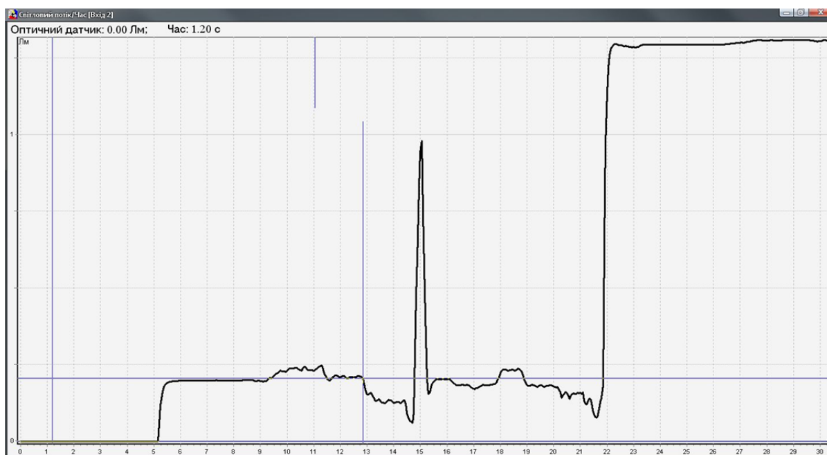
Рис. 4.12. Вікно програми «Лабораторія МІГ-1.3». Приклад визначення прозорості желейних систем
