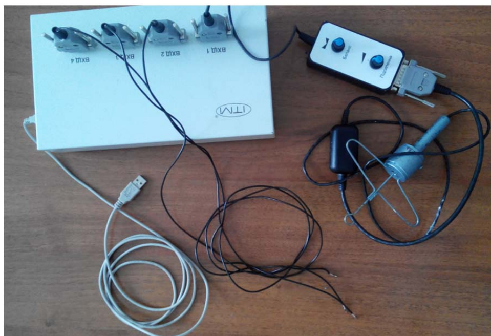
Рис. 2.17. Установка для визначення тиску всередині рідких харчових продуктів в процесі термічної обробки
