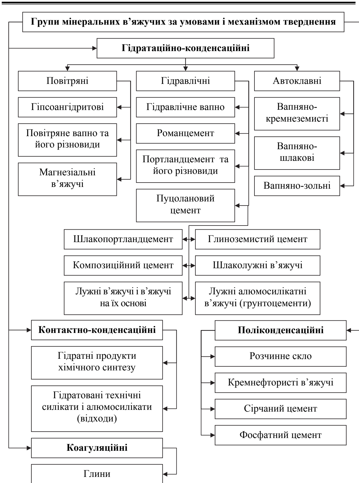
Рис. 3.18. Класифікація мінеральних в'язучих за умовами і механізмом тверднення (класами) за ДСТУ Б В.2.7-91-99
