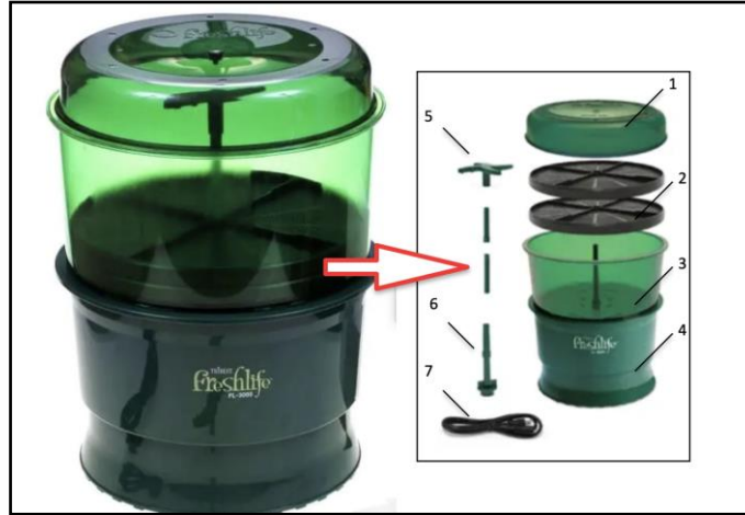
Рисунок 3.2 – Пристрій для пророщування насіння льону: 1 – кришка пророщувача; 2 – сито (2 шт.) для насіння; 3 – корпус пророщувача; 4 – основа з водою, електроприводом і насосом подачі води; 5 – розприскувач; 6 – трубка тиску води; 7 – шнур живлення
