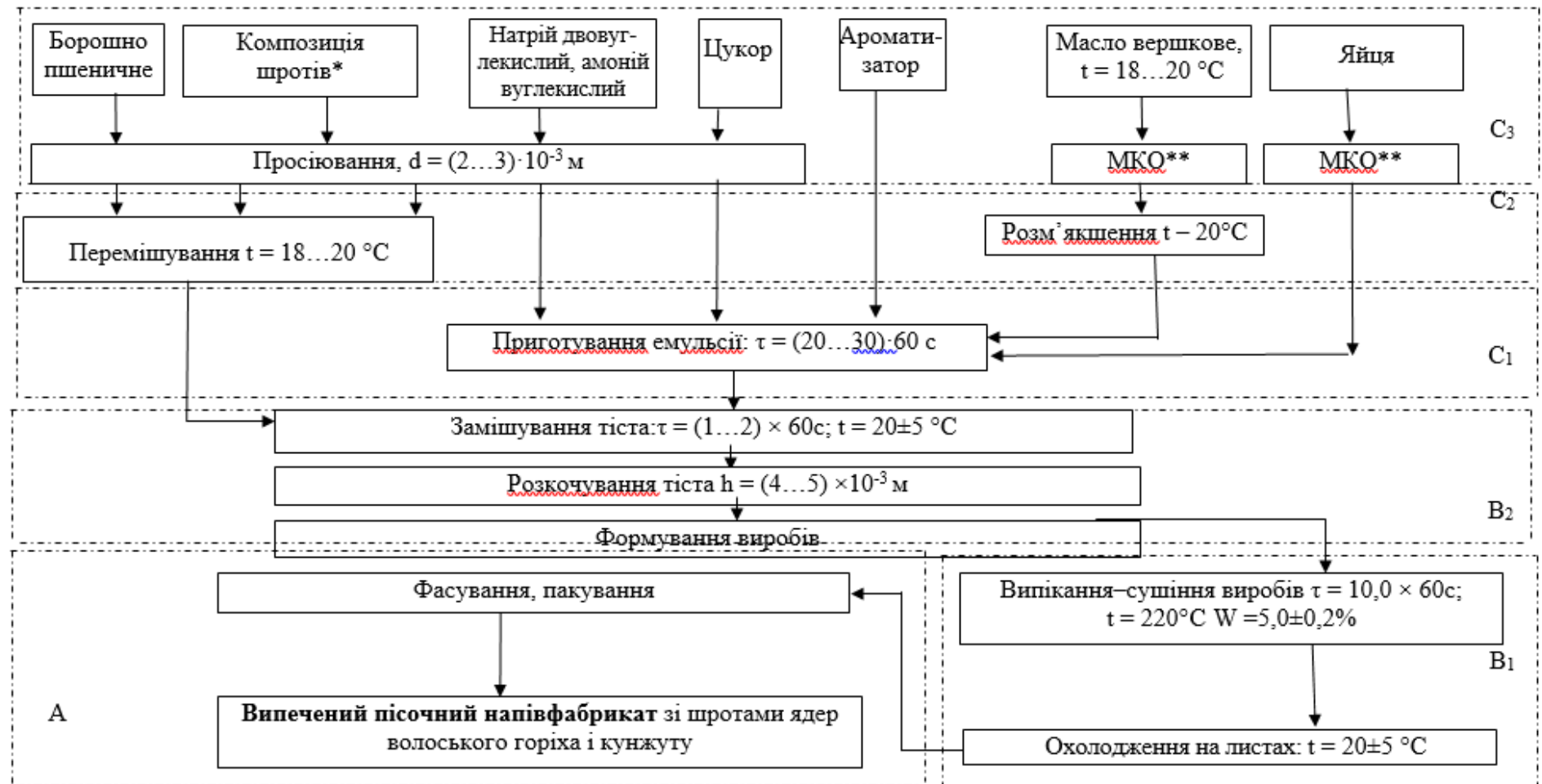
Рис. 6. Технологічна схема приготування пісочних виробів з композицією шротів ядер волоського горіха і кунжуту: C 3 – просіювання, розчинення і механічне кулінарне оброблення продуктів; C 2 – підготовка і диспергування компонентів; C 1 – перемішування компонентів; B 2 – замішування тіста та формування виробів; B 1 – випікання виробів; A – фасування і упакування виробів
