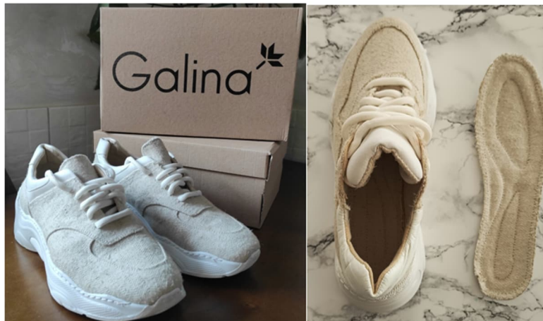
Рис. 8. Експериментальні зразки текстильного взуття з верхом із тканого полотна з модифікованого конопляного волокна
