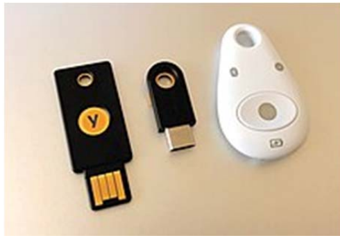
Рис. 1. Апаратні ключі двофакторної авторизації
