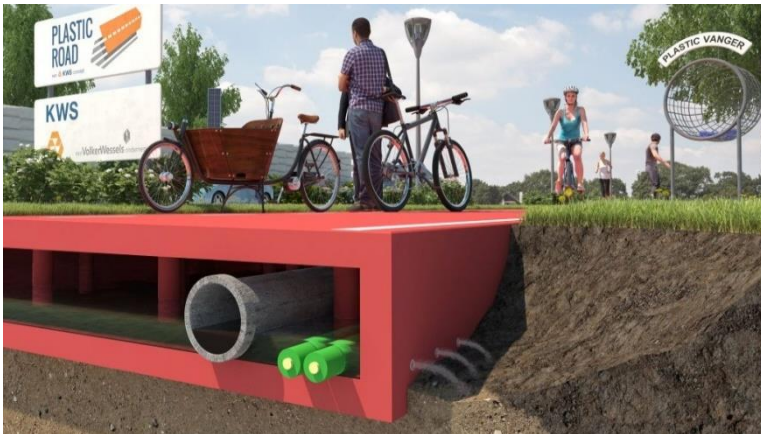
Рис. 1. Структура пластикової дороги
