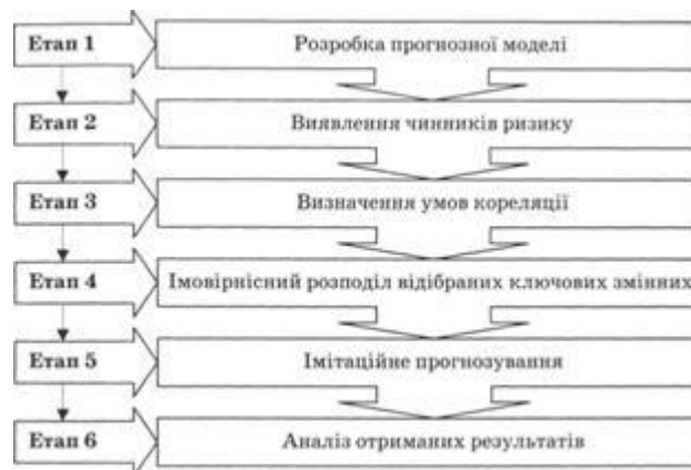
Рис. 2. Блок-схема імітаційного моделювання за методом Монте-Карло
